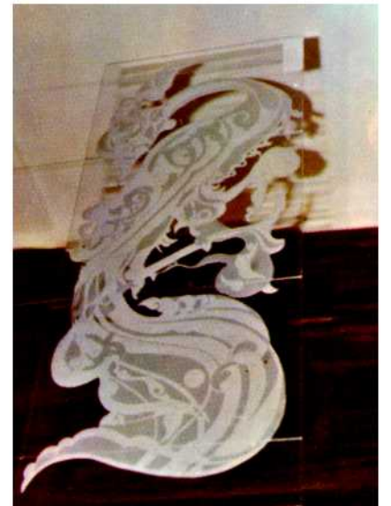
لوح زجاجى مشكل بطريقة الحفر بواسطة الحمض
