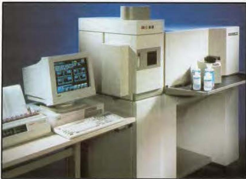
صورة (٤) : جهاز ICP بمعمل التحاليل الكيميائية
